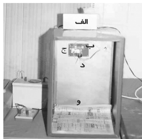
شکل ۱- سیستم آزمایشگاهی ویژه مولد امواج شبیه‌سازی شده تلفن‌های همراه ( 940\text{ MHz} ) جهت بررسی این امواج بر باروری موش ماده نژاد Balb/C: الف) منبع تغذیه، ب) مولد فرکانس (VCD)، ج) تقویت کننده، د) آنتن، و) اتاقک
